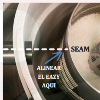
Figura 10. Alinear la costura del Eazy con el centro de la tubería de rebose.
